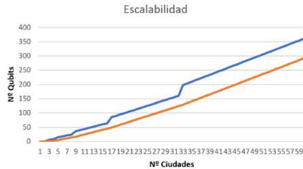
Figura 6: Comparación de la escalabilidad de las distintas codificaciones. La recta azul representa la codificación basada en ciudades, y la recta naranja la codificación basada en número de saltos.
